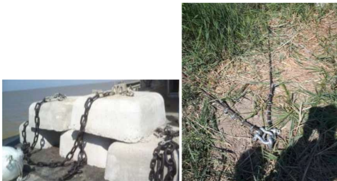
Figure 14 : Corps mort (gauche), ancre à vis (à droite)
